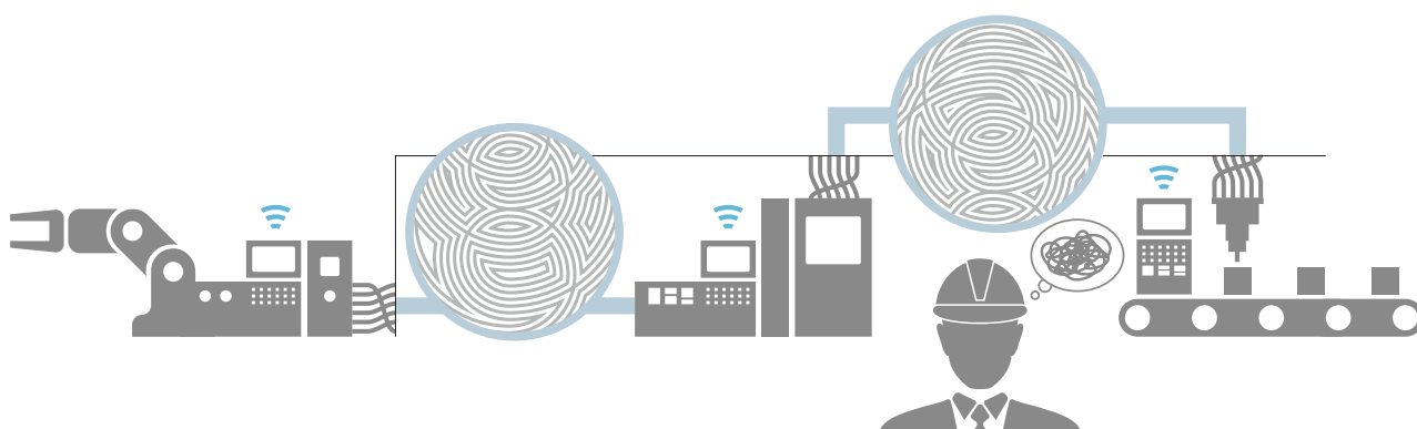
図3. 製造現場におけるレイアウト変更を妨げるケーブル
