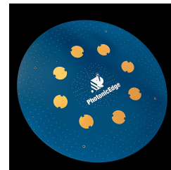
8素子アレーアンテナ (UCA: Uniform Circular Array)
